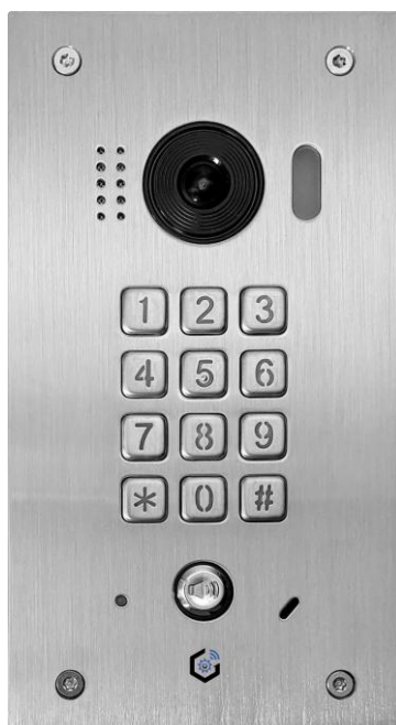
SM-611EAV Caméra 170° encastrée INOX 316 à 1 bouton d'appel avec clavier à codes anti-vandale rétro-éclairé 1 sortie 12Vdc 280mA livrée avec relais SM-611EAV 600€ HT EAN 3760001987331
