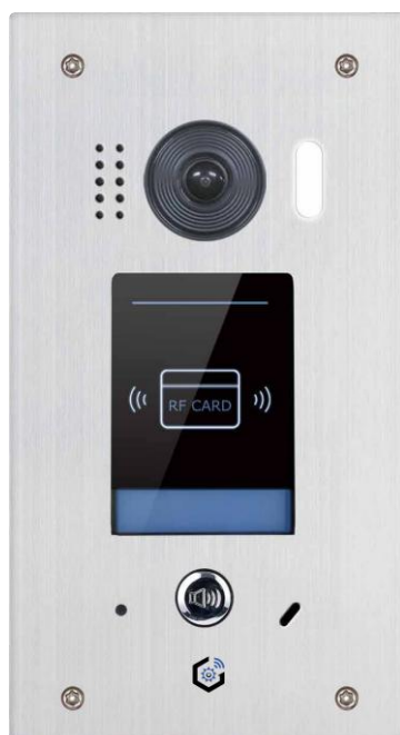
SM-611PE Caméra 170° encastrée INOX 316 à 1 bouton d'appel avec lecteur de badges rétro-éclairé 1 sortie 12Vdc 280mA livrée avec relais SM-611PE 500€ HT EAN 3760001987324
